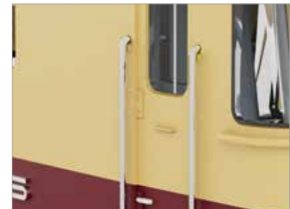
■ Rambardes métalliques sur les montées
