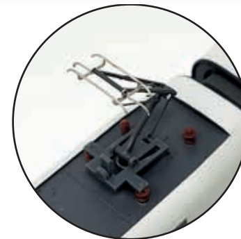
Feine Stromabnehmer, größtenteils aus Metall gefertigt
